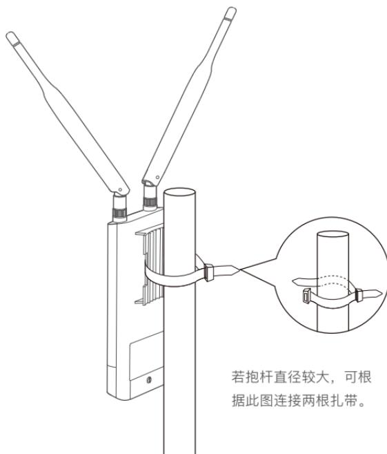
若抱杆直径较大, 可根据此图连接两根扎带。
