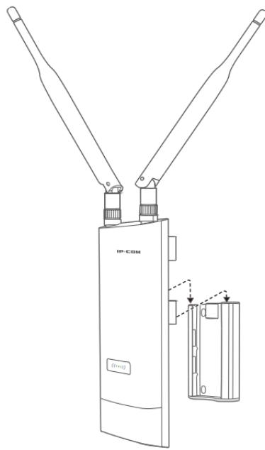
5. 用螺丝刀将防盗螺钉拧入防盗孔中。
