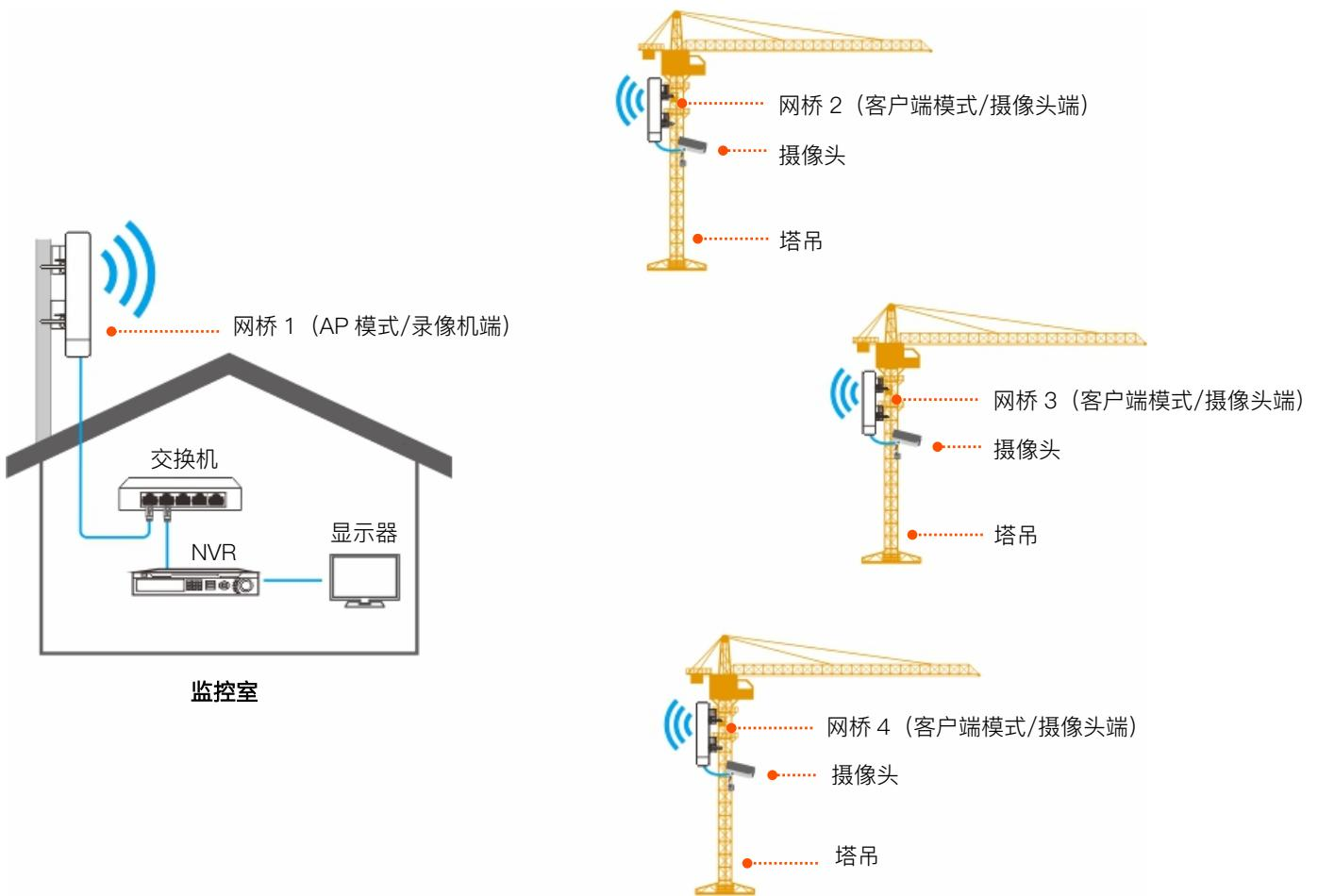
您可以根据指示灯检查网桥安装位置是否合适。网桥的接收信号强度指示灯（如：LED1、LED2、LED3）均长亮或闪烁时，桥接质量最好，安装位置最佳。
