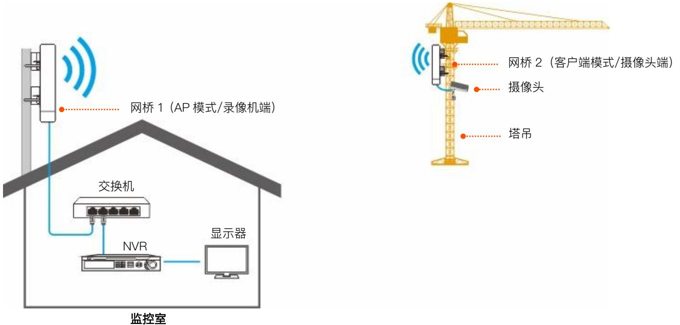
1 对多桥接安装示意图如下。(以 1 对 3 桥接为例)
