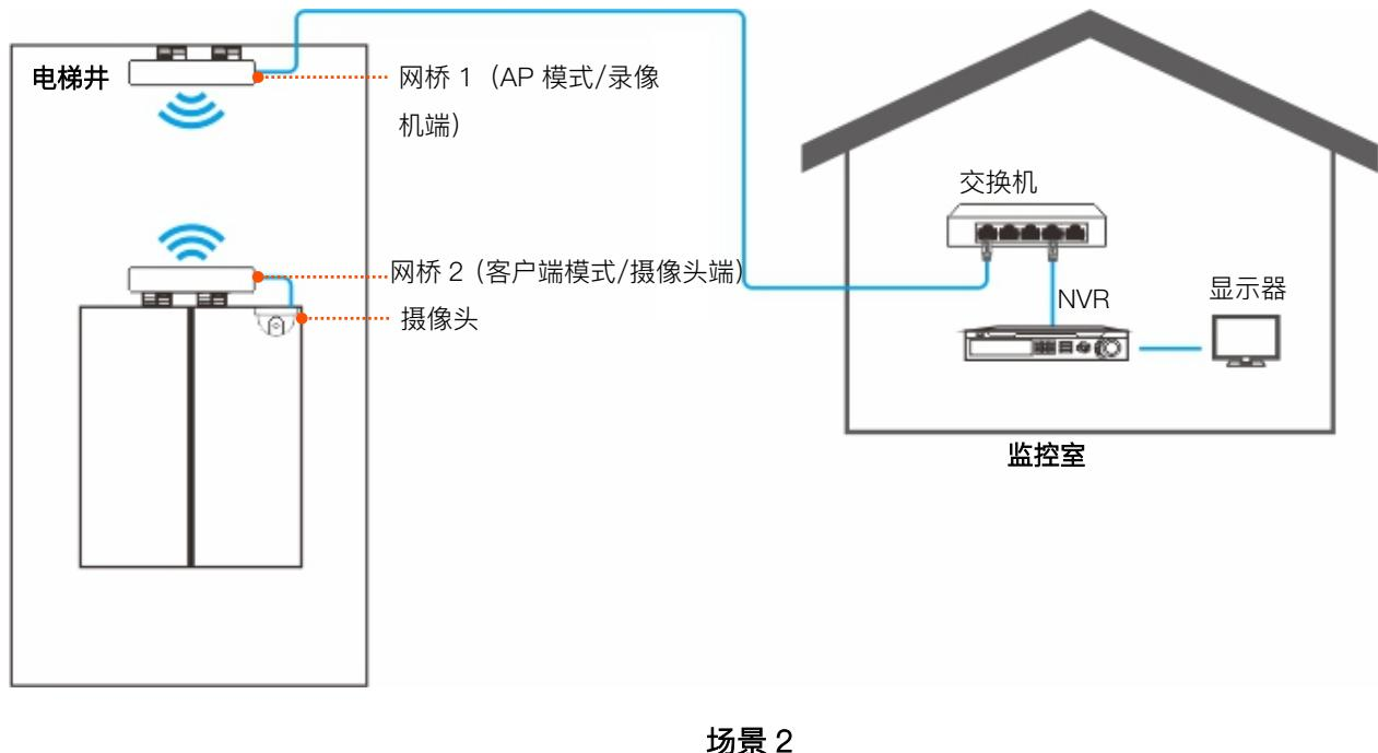
您可以根据指示灯检查网桥安装位置是否合适。当网桥的接收信号强度指示灯（如：LED1、LED2、LED3）均长亮或闪烁时，桥接质量最好，安装位置最佳。
