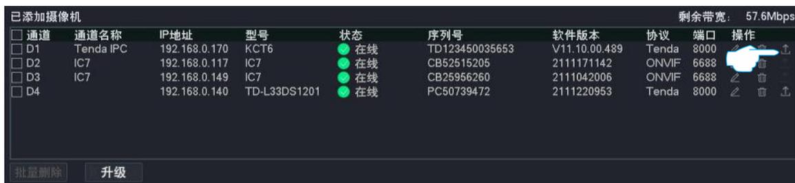
**步骤 5** 1 分钟内拔出鼠标并插入根目录存有升级文件的 USB 存储设备。摄像机将自动升级。
