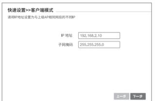
提示: 点击保存, 等待网桥自动重启使设置生效。当第1个网桥的 LED1、LED2、LED3 灯长亮, 第2个网桥的 LED1、LED2、LED3 灯闪烁时, 桥接成功, 网桥的 DHCP 服务器均自动关闭。如果需要 1对多桥接, 请参考步骤4, 设置其工作在客户端模式并桥接第1个网桥的无线网络, 以此类推。
