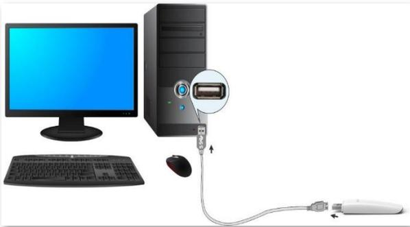
方式 2：直接将无线网卡插入电脑的 USB 接口。
