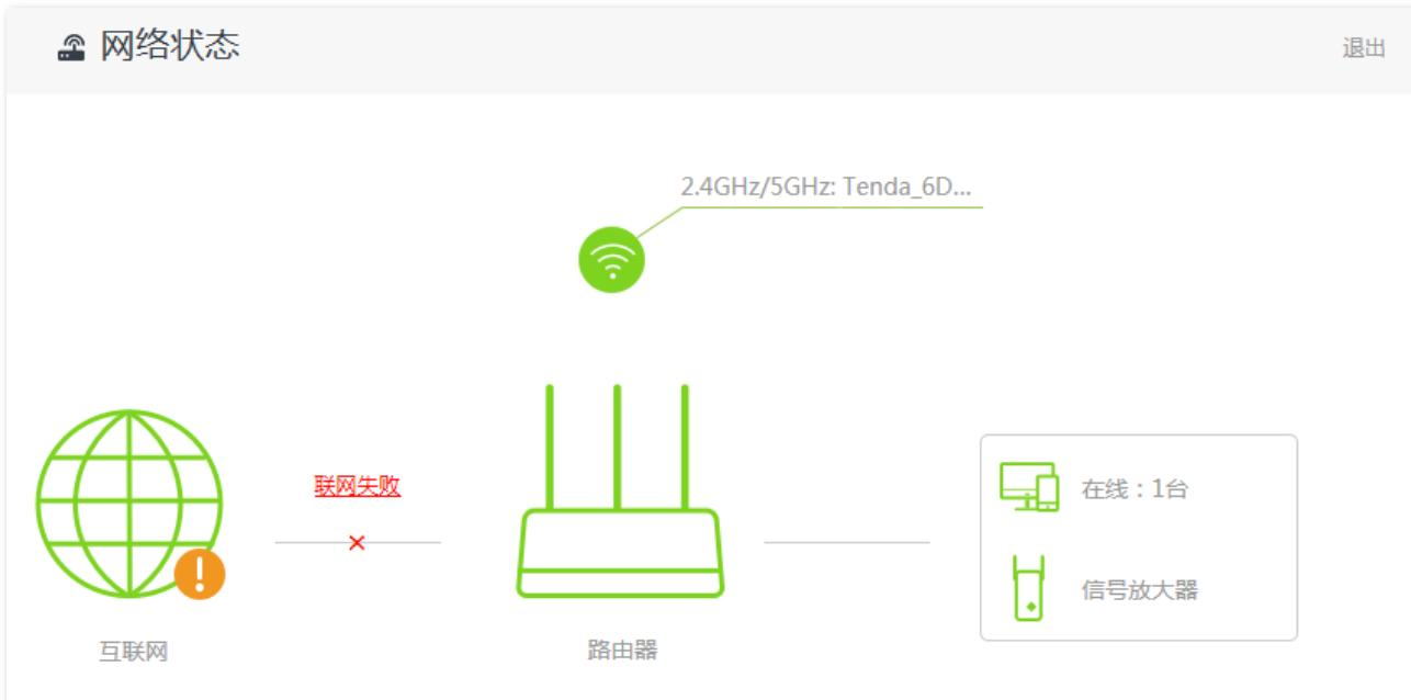
当“联网状态”显示“**WAN 口未插网线，请检查并连接好 WAN 口网线**”，如下图示，表示 WAN 口网线连接异常。请检查 WAN 口网线的两端是否插紧，如果网线已插紧，但仍然显示异常，请联系 Tenda 技术支持（热线：400-6622-666）。
