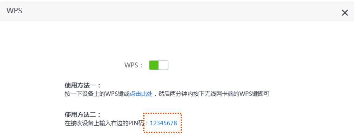
**步骤 2** 在无线终端设备上输入路由器的 PIN 码进行连接，**2 分钟内**，连接成功。
