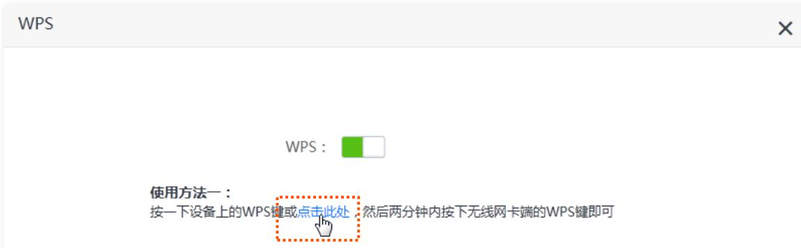
**步骤 4** 2分钟内，在无线终端设备上设置 WPS。不同无线终端设备设置 WPS 方法不尽相同，此处以华为手机 P10 为例。
