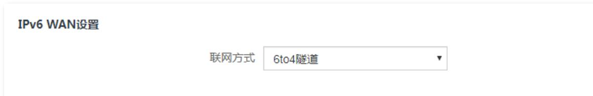
**步骤 2** 参考**步骤 1**，设置路由器 2 的 WAN 口 IPv6 联网方式为“6to4 隧道”。
