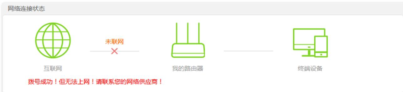
当“互联网”与“我的路由器”之间线路打叉，且页面提示“**路由器已获得一个有效的IP地址但无法上网，请尝试以下操作：**”，如下图示。请根据页面提示操作，如果仍然显示异常，请联系 Tenda 技术支持（热线：400-6622-666）。
