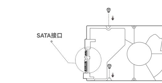
● 将硬盘SATA接口对准录像机主板上的SATA接口, 然后平稳推入直到插紧。
