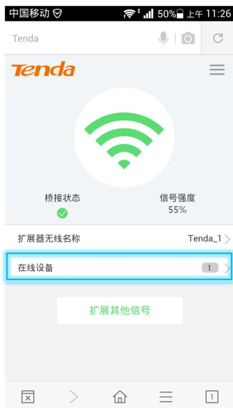
点击“在线设备”，可以查看终端设备详情（设备名称、IP 地址）。如果发现未知设备，可以将其拉黑。已经拉黑的设备，将显示在下方的黑名单中，且不能连接到扩展器。
