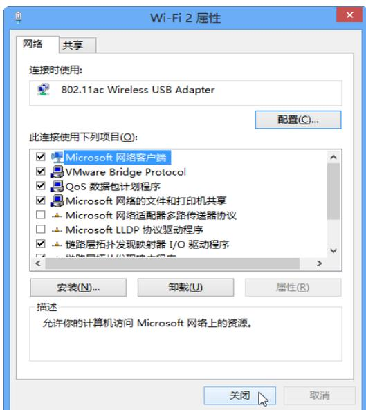
9. 自动返回到【Wi-Fi 属性】窗口，点击 **关闭** ，完成配置。
