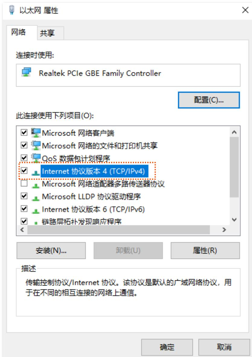
步骤 6 选择自动获得 IP 地址，自动获得 DNS 服务器地址，点击 确定。
