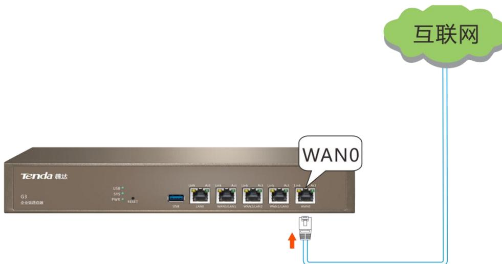
2. 用网线连接路由器和其它网络设备（服务器、电脑等）。检查无误后，使用产品包装盒内的电源适配器连接路由器和电源插座，按下电源开关给路由器上电。
