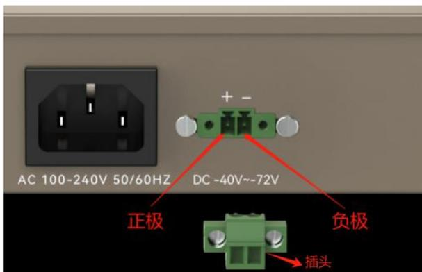
3. 将接好电缆的 DC 插头插入到 OLT 设备的 DC 连接座中。
