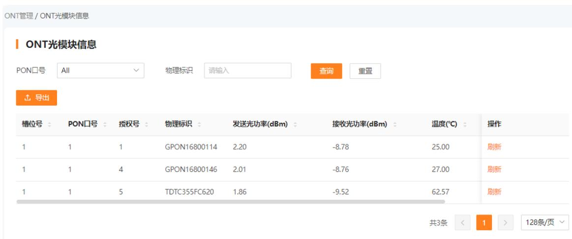
**步骤 4** 找到要更新的光模块信息条目，点击**刷新**，更新单条 ONT 的光模块参数信息。下图仅供参考。
