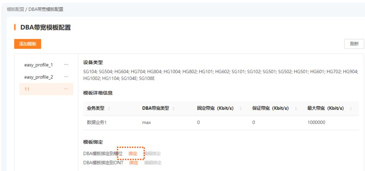
**步骤 4** 配置“DBA 模板绑定”为“绑定”，选择待绑定的槽位后，点击 **应用配置**。
