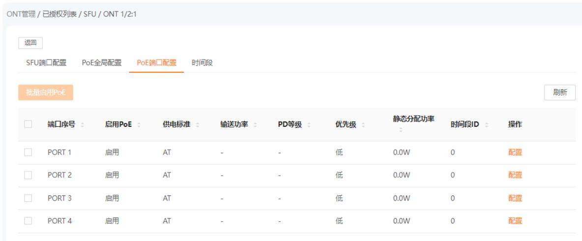
**步骤 5** 配置 PoE 端口参数后，点击**应用配置**。下图仅供参考。
