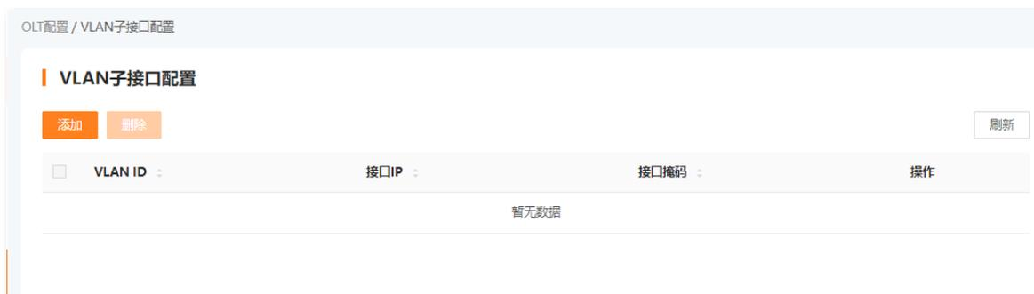
**步骤 4** 配置 VLAN 子接口参数后，点击 **应用配置**。
