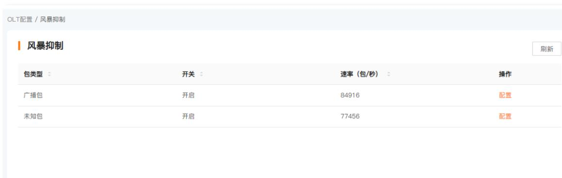
**步骤 4** 开启风暴抑制功能，设置每秒可接收的数据包最大值后，点击**应用配置**。下图仅供参考。
