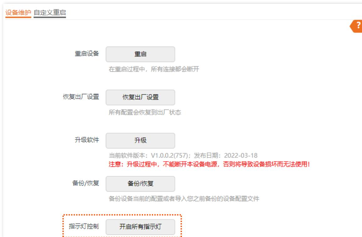
设置完成后，AP 的指示灯重新亮起，您可以根据指示灯判断 AP 的工作状态。
