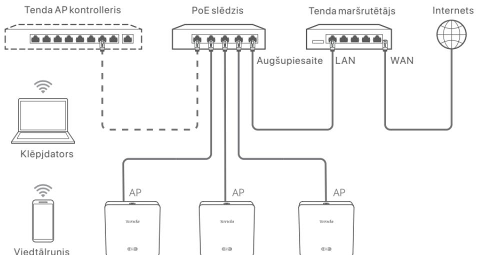
(W15-Pro tiek izmantots, piemēram. Citu modeļu elektroinstalācija ir līdzīga neatkarīgi no to izskata.)
