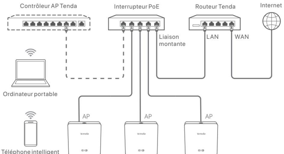
(W15-Pro utilisé par exemple. Le câblage des autres modèles est similaire quelle que soit leur apparence.)
